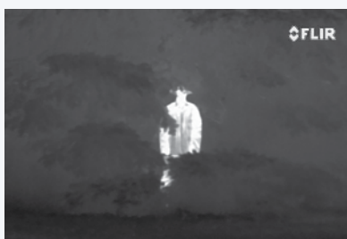
Imagerie thermique : le suspect caché dans les buissons est nettement visible, car le contraste thermique est pratiquement impossible à masquer.
